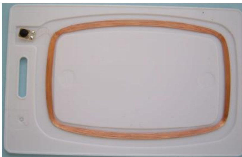
Rys. 3.5 Karta ze zdemontowaną tylną częścią obudowy – widoczna cewka i układ scalony
