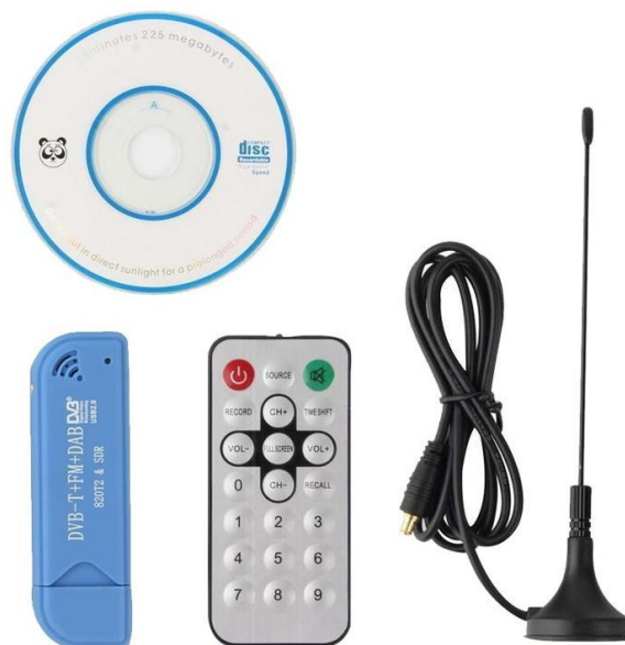
Rys. 8.1 Odbiornik DVB-T, podłączany do komputera przez port USB, jako tani odbiornik SDR
